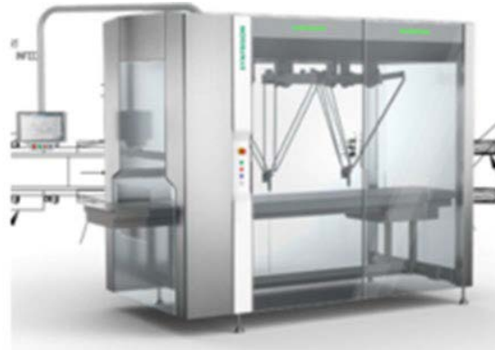
Robotisierter Belader „RPP“
